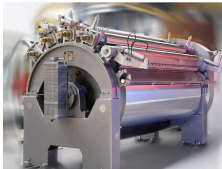
Figure 49 : les sécheurs à tambours
