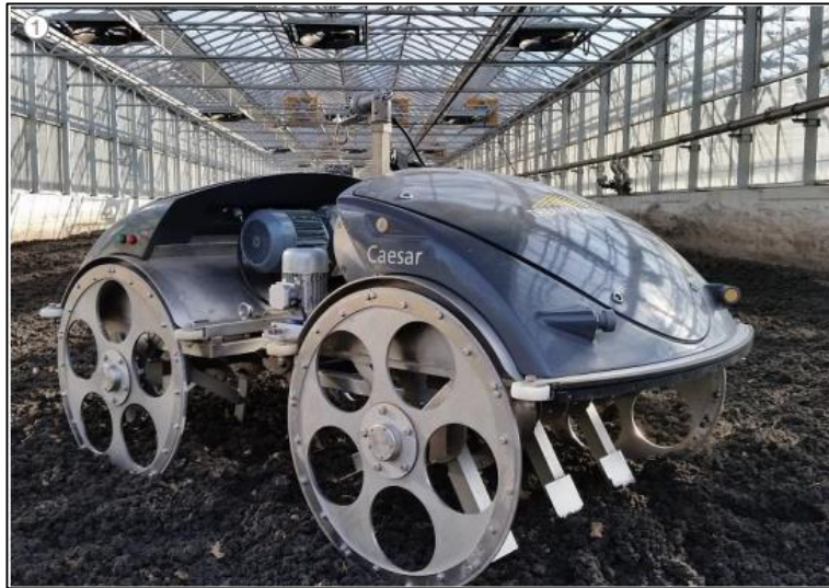
Figure 52 : Retournement des boues par sanglier électrique (Source thermo-system)
